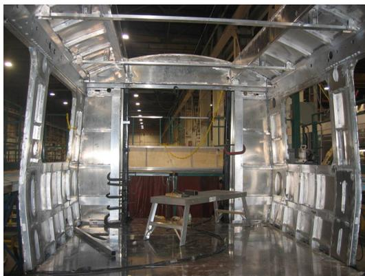
图 5 机场线车辆采用的车体结构
