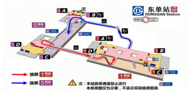
图 5 东单地铁站站型结构与换乘流线
