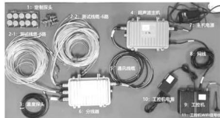
图 3-2 超声波测试试验器材套件
