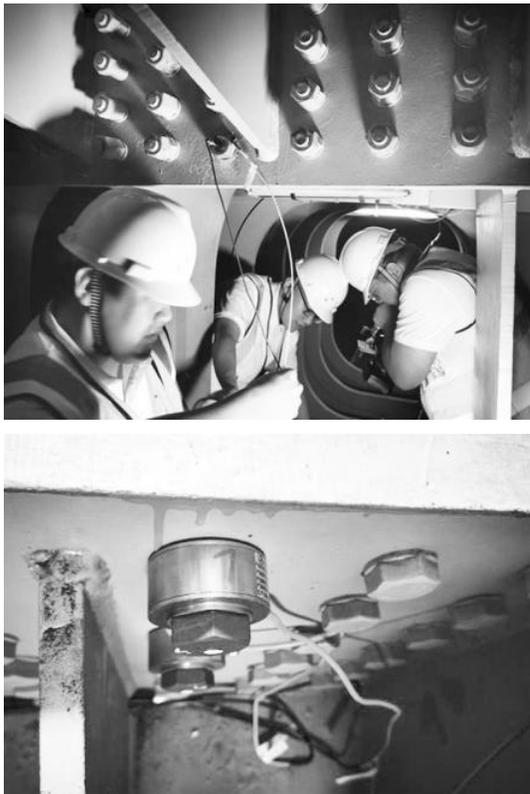
图 3-6 大桥现场超声波测试与压力环同步轴力采集照片
