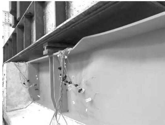
图 8 试验梁破坏
