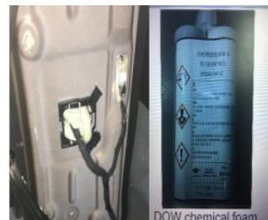
图 11 锁销安装点动刚度手工加强方案
