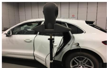
图3 关门声品质试验现场
