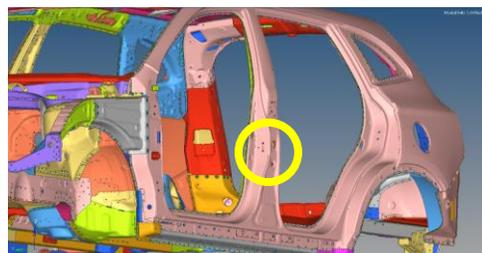
图 15 车门锁销安装点结构
