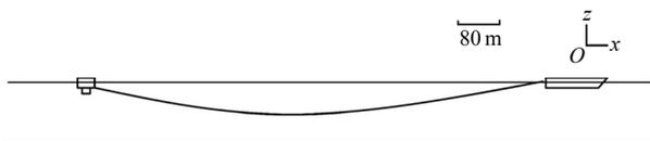
图 10 单点浮筒拖航 OrcaFlex 分析模型
