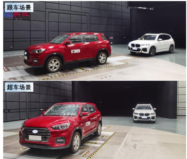
图 7 风洞跟车、超车试验测试现场
