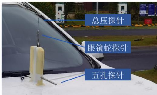
图1 真实道路来流参数测量系统
