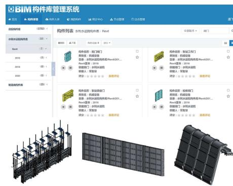
图7 基于构件库的金属结构模型实例化
